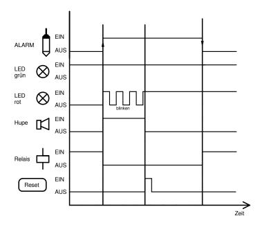
Fall 2: Alarm kommt und steht → Reset wird gedrückt, Alarm wird guittiert, nach Beseitigung der Alarmursache geht die rote LED wieder aus.
