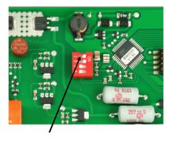
Mit dem DIP-Schalter 1 auf der Elektronikplatine im Sensorspeisegerät kann die Hupe dauerhaft ausgeschaltet werden. Der Alarm wird dann nur noch optisch und über die eingebauten Alarmrelais signalisiert.
