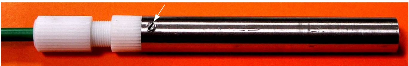
Handfestes Einschrauben von Gewindedruckstück in Elektrodengehäuse und anschließendes anziehen der Kontaktschraube
