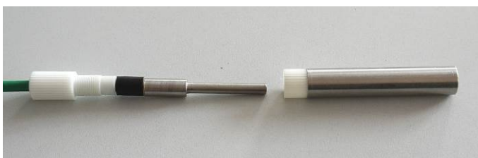
Gehäuserohr aufsetzen und mit oberem Teil verschrauben
