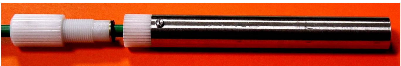
Einsetzen von Kabel mit aufgesetzten Teilen in Elektrodengehäuse bis Anschlag
