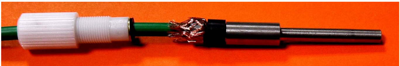
Aufsetzen von Elektrodeninnenleiter
