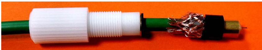
Aufstecken von Neopren- und Messingdruckstück und Abknicken von Innenleiter
