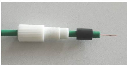
Neoprendichtung (Ø10,5x2 - 14,5mm) aufsetzen
