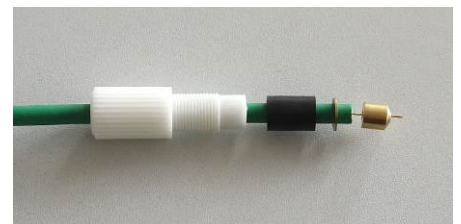
Messingdruckstück (ca. Ø8x8,5mm mit Konus) aufsetzen
