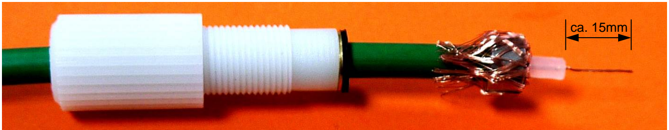
Abisolieren von Dielektrikum des Koaxialkabels
