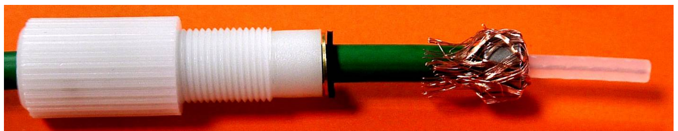
Vorschieben von Edelstahlring bis auf Vorderkante Kabelmantel und Überstülpen von Kabelschirm
