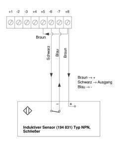
**Anschluss eines NPN** NF-Durchflussdetektors (194 831)
