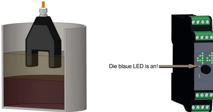
**ACHTUNG: Beim Wechsel des Messbereichs (Von HIGH zu MEDIUM, von MEDIUM zu LOW) leuchtet die blaue LED auf und das Relais schaltet - dies zeigt nur den Messbereichswechsel an.**
