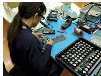
Prüfung auf elektrische und mechanische Funktion
