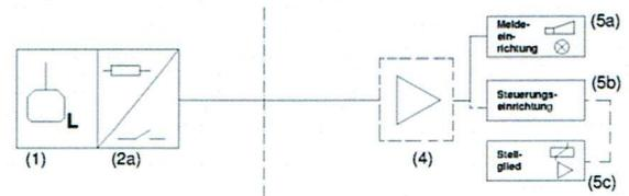
Standaufnehmer mit integriertem Messumformer (2a) mit binärem Ausgang
