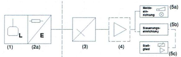
Standaufnehmer mit integriertem Messumformer (2a) mit Strom-Ausgang
