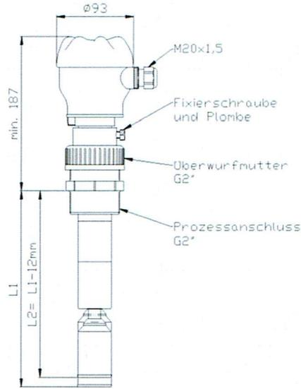
**Schema der Überfüllsicherung**
