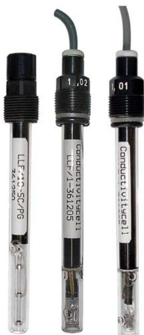
Die Elektroden der Serie BF1200 bestehen aus einem Glasrohr Ø12mm mit 120mm Länge, mit Pg13,5-Befestigung und einem Messelement aus Platin. Die Elektroden des Typs BF1200 haben einen Stecker (Typ 9054), durch den der elektrische Anschluss hergestellt wird. Die BF1205-Sonde wird mit einem vieradrigen Kabel (Länge 1000mm) angeschlossen.
