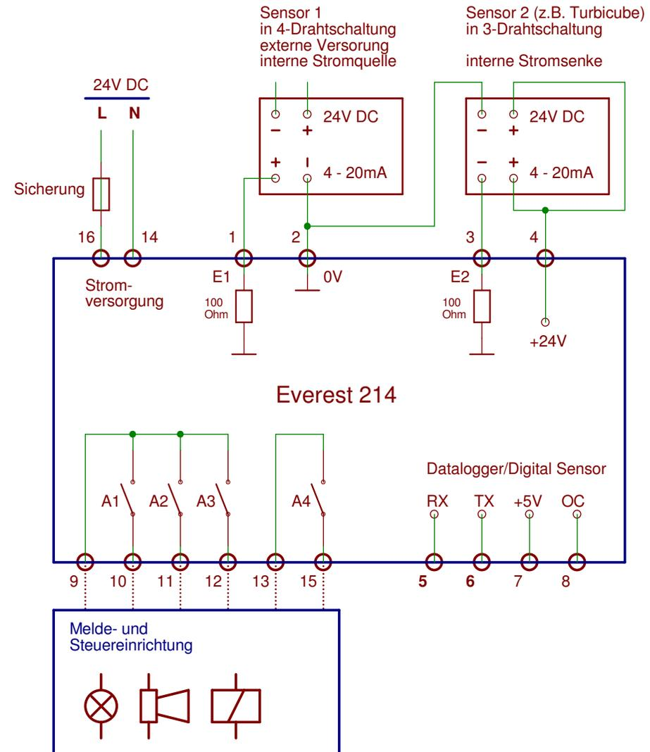
**Anschlussbeispiel für Sensoren wahlweise in Zweidraht- oder in Drei- / Vier-Draht-Schaltung**
