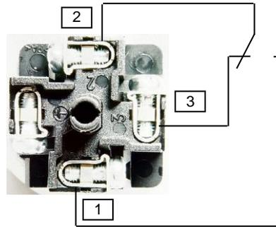
**Anschluss:** Kontaktstellung im unterfahrenen Zustand
