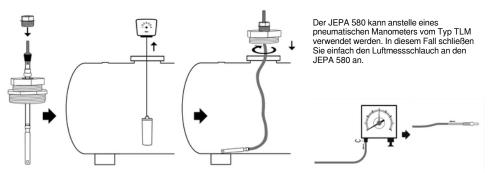
Mögliche Montage anstelle einer mechanischen oder pneumatischen Messung.
