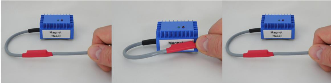
Zum Durchführen des Reset hält man den im Kabel integrierten und durch einen roten Schrumpfschlauch markierten Magnet an den Aufkleber mit der Aufschrift "MAGNET RESET".
