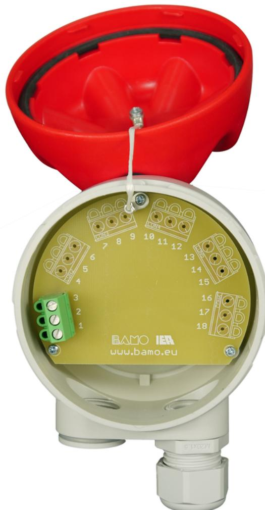
Klemme 1 ist stets der Anschluss der kürzesten Elektrode. Die Zahlen sind der Elektrodenlänge zugeordnet. Die längste Elektrode hat die größte Zahl.
