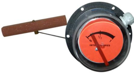
Der Schwimmer betätigt eine Schiebestange mit einer Eckumlenkung. Diese Bewegung wird auf die Skalenscheibe übertragen und somit der Füllstand angezeigt.
