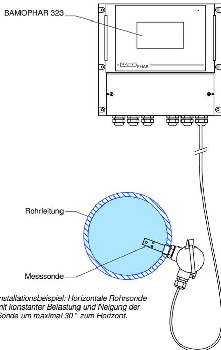
Installationsbeispiel: Horizontale Rohrsonde mit konstanter Belastung und Neigung der Sonde um maximal 30° zum Horizont.
