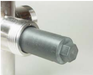
Druckstück mit dem mitgelieferten Werkzeug herauserschrauben und herausnehmen
