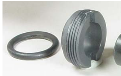
danach Dichtungsring herausnehmen
