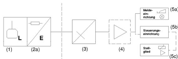
Standaufnehmer mit integriertem Messumformer (2a) mit Strom-Ausgang
